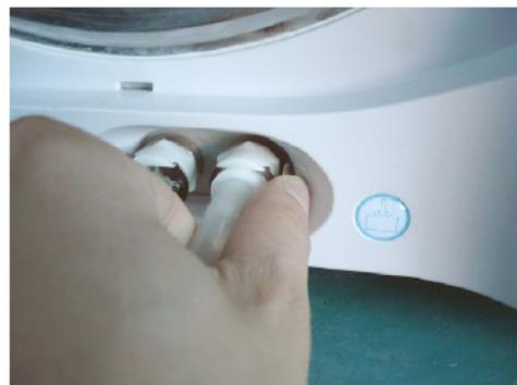
2. Отключение быстросъемного соединения.
